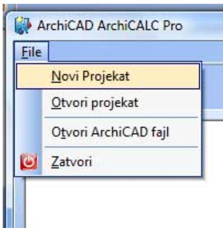
Definitivno završen model, koji u ArchiCAD-u ima ekstenziju \*.pln , treba biti snimljen u \*.pla (ArchiCAD Solo Project Archive) fajl. Taj fajl treba prebaciti kalkulantu koji će ga učitati u programa NormAG. (Kalkulan na svom računaru NE MORA da ima instaliran program ArchiCAD, već samo i obavezno ArchiCAD ODBC drajver koji se isporučuje na instalacinom CD programa NormAG).
