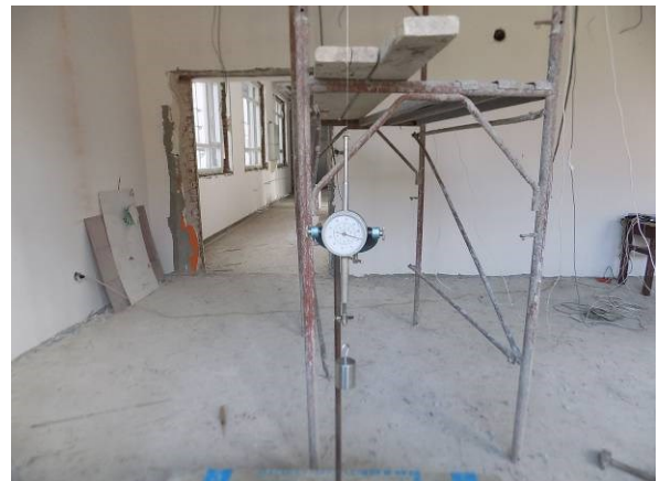
Slika 5 – Ugibomer sat sa žicom (U3)
