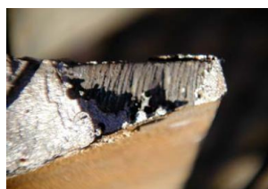
Slika 23 - Nedovoljno spajanje u nožici šine
