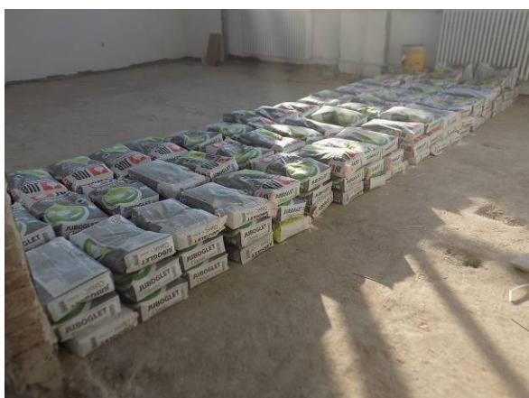
Slika 8 – Deveti korak nanošenja probnog opterećenja ( P_9=360 \text{ daN/m}^2 )
