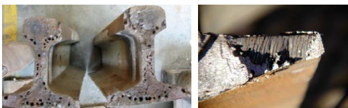
Slika 22 - Poroznost u zavariva
