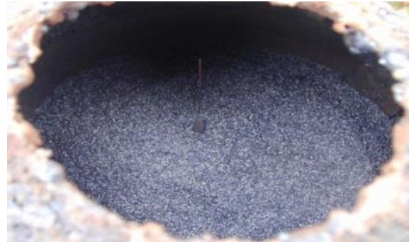
Slika 13 - Prskalica i termitna masa u loncu
